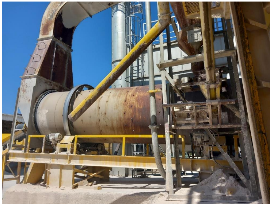
Слика 7. Ротациона мешалка тип (TAP – 800LB+SB-60) за сушење на агрегатот и мешање на суровините за производство на асфалт. Ротационата мешалка се врти со помош на
