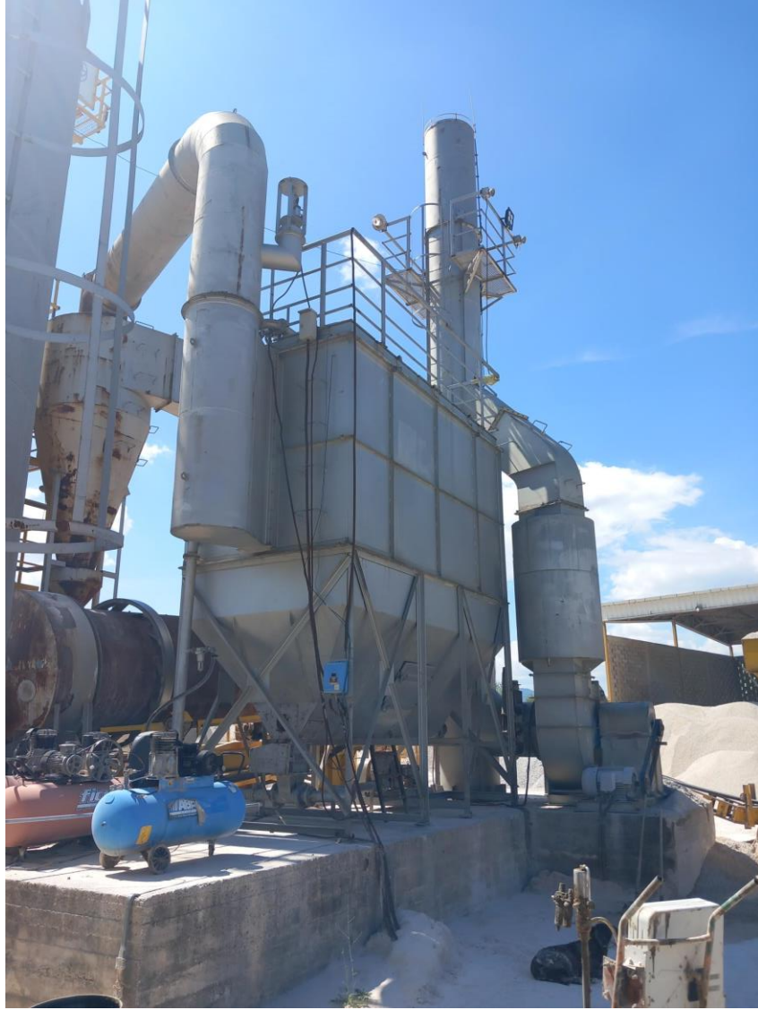
Слика II.8. Систем за отпращување на димните гасови од ротационата мешалка кој што се состои од циклон и комора за вреќести филтри.
