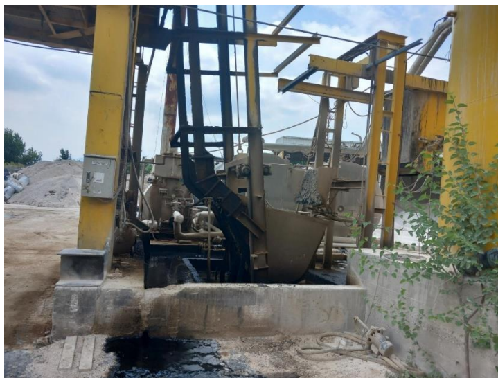
Слика II.15. Корпа за собирање готов асфалт од ротационата мешалка.
