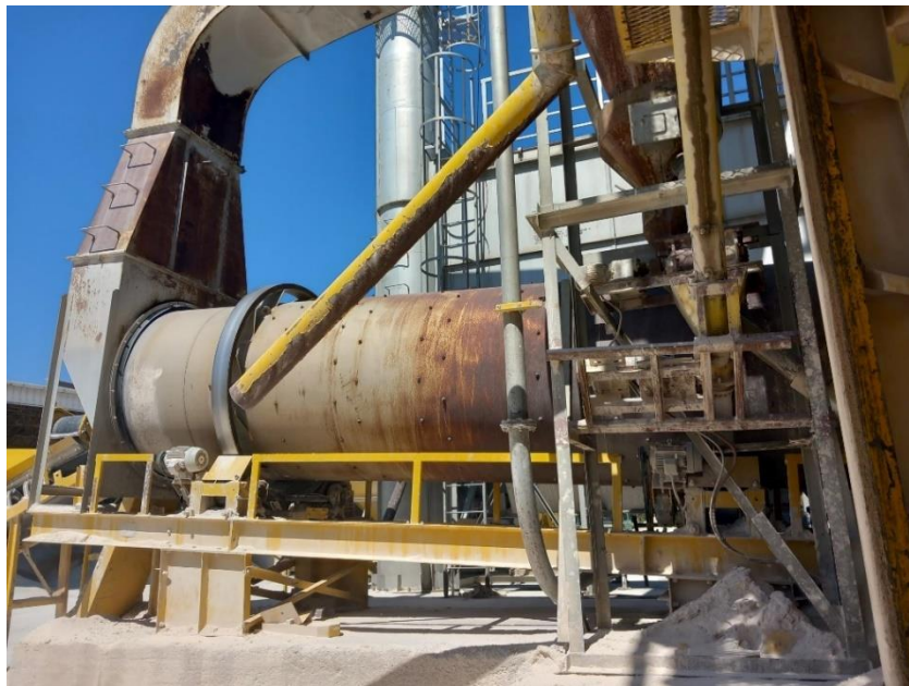
Слика II.7. Ротациона мешалка тип (TAP – 800LB+SB-60) за сушење на агрегатот и мешање на суровините за производство на асфалт.
