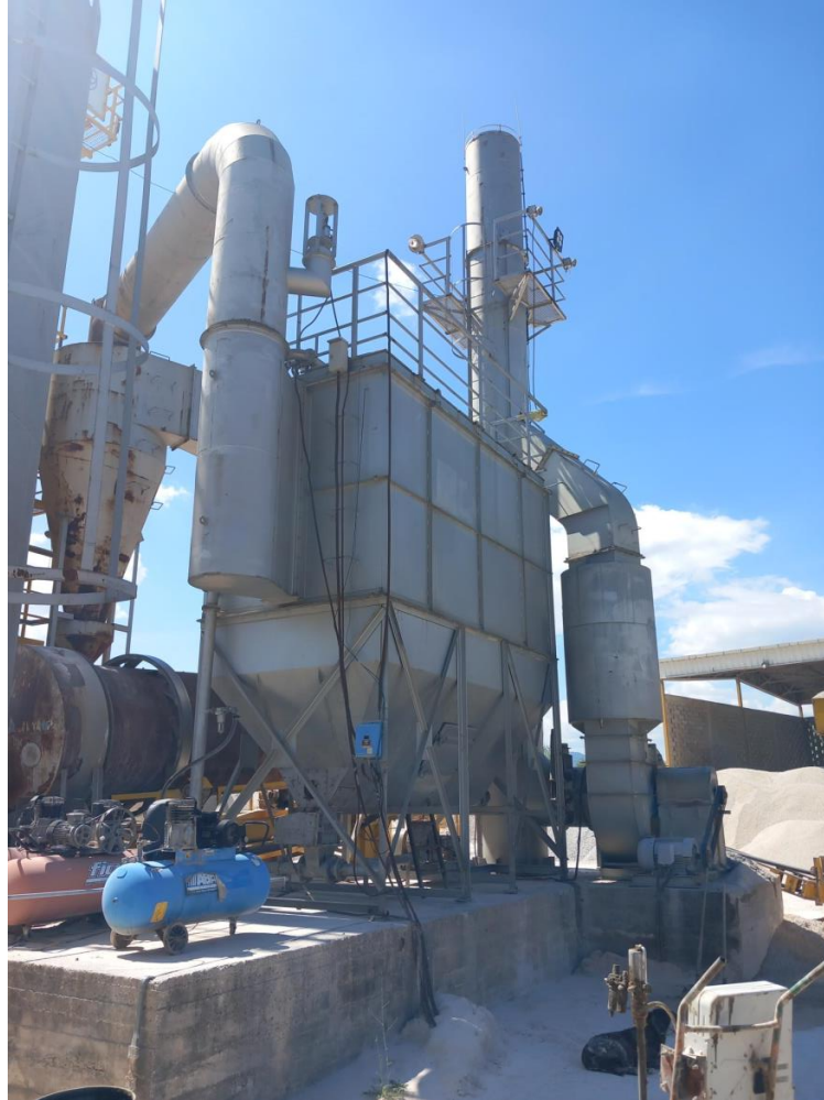
Слика 8. Систем за отпрашување на димните гасови од ротационата мешалка кој што се состои од циклон и комора за вреќести филтри.
