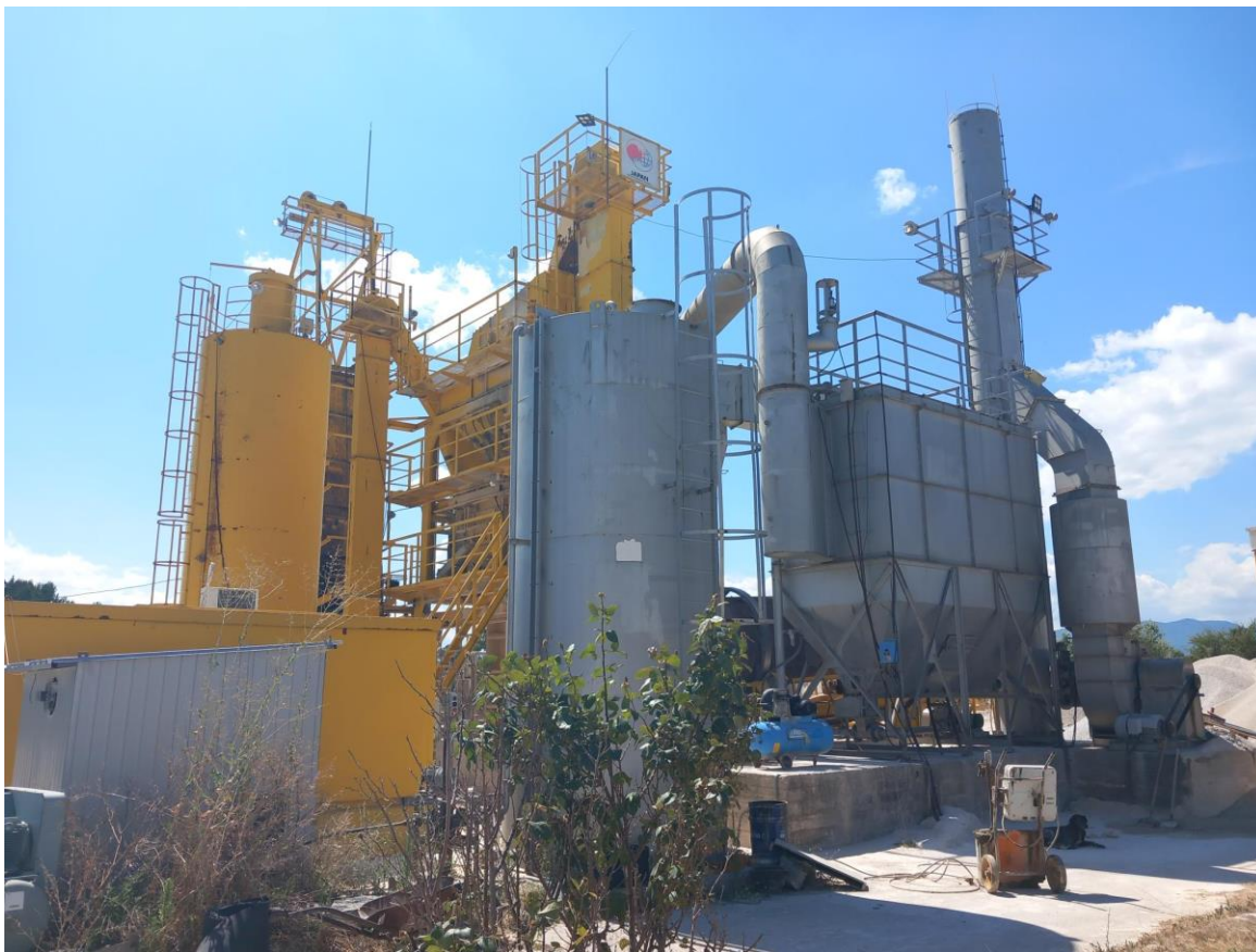
Слика 4. Асфалтна база „Лепенец“ на ЈП за одржување и заштита на магистралните и регионалните патишта – Скопје ц.о. Проектиран капацитет: 60 t/h.
