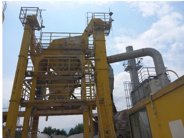
Слика II.16. Систем за дозирање готов асфалт во камиони непосредно откако е произведен.
