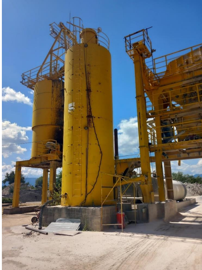
Слика II.13. Силос за складирање филер со капацитет од 60 t.
