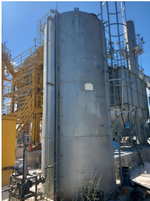
Слика II.14. Вертикален резервоар со капацитет од 20 m 3 за горивото потребно за технолошки процес за производство на асфалт (екстра лесно масло ЕЛ-1).
