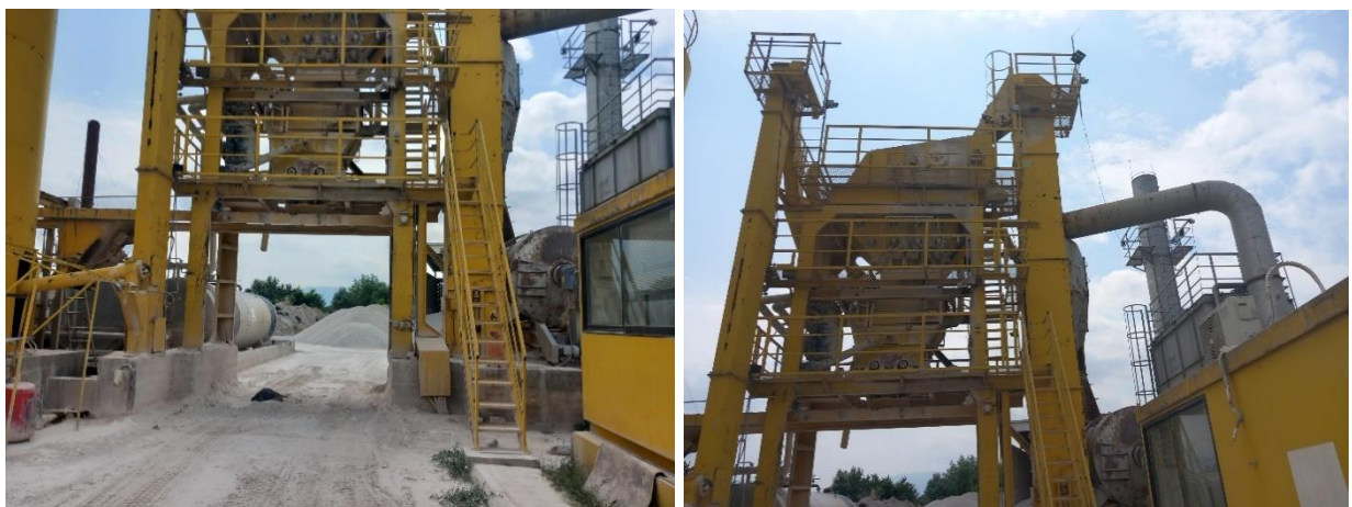
Слика 15. Корпа за собирање готов асфалт од ротационата мешалка.
