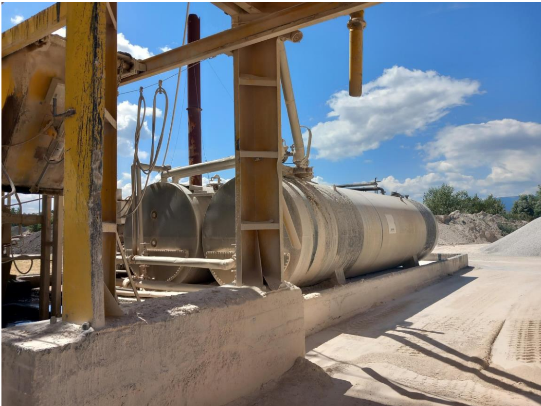
Слика 9. Две хоризонтални термоцистерни со поединечен капацитет од по 30 t, наменети за складирање битумен во втечнета состојба.
