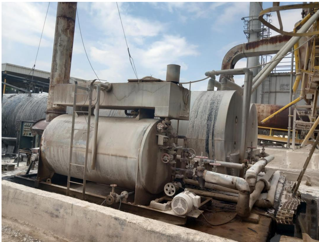
Слика 10. Систем за загревање на битумен. Битуменот се загрева во термоцистерните со термичко масло за топлинска размена (терманол) кое што претходно се загрева во казан со горилник кој како гориво користи екстра лесно масло ЕЛ-1.
