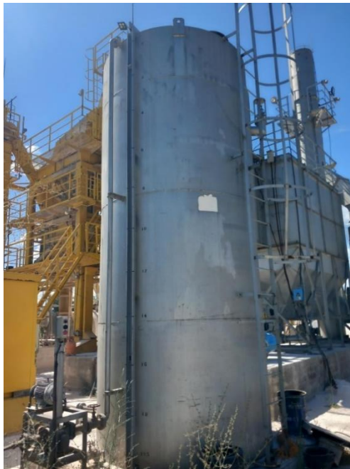
Слика 14. Вертикален резервоар со капацитет од 20 m 3 за горивото потребно за технолошкиот процес за производство на асфалт (екстра лесно масло ЕЛ-1).
