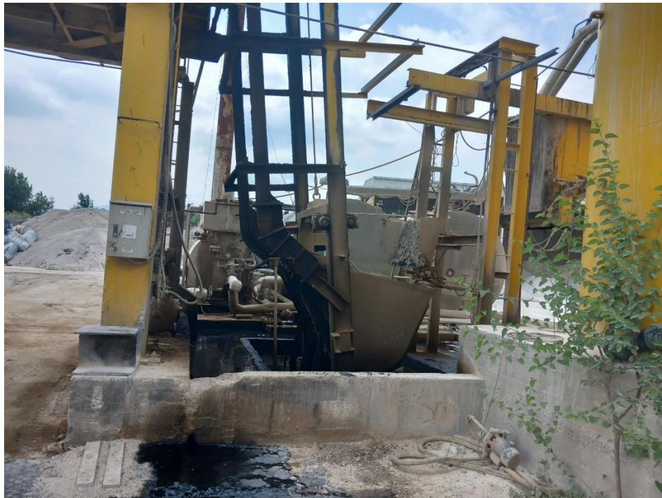
Слика 15. Корпа за собирање готов асфалт од ротационата мешалка.
