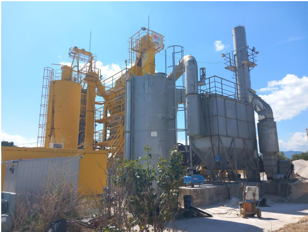
Слика II.4. Асфалтна база „Лепенец“ на ЈП за одржување и заштита на магистралните и регионалните патишта – Скопје ц.о. Проектиран капацитет: 60 t/h.
